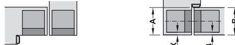
Preparing installation ขนาดรูเจาะสำหรับบานพับซ่อน
